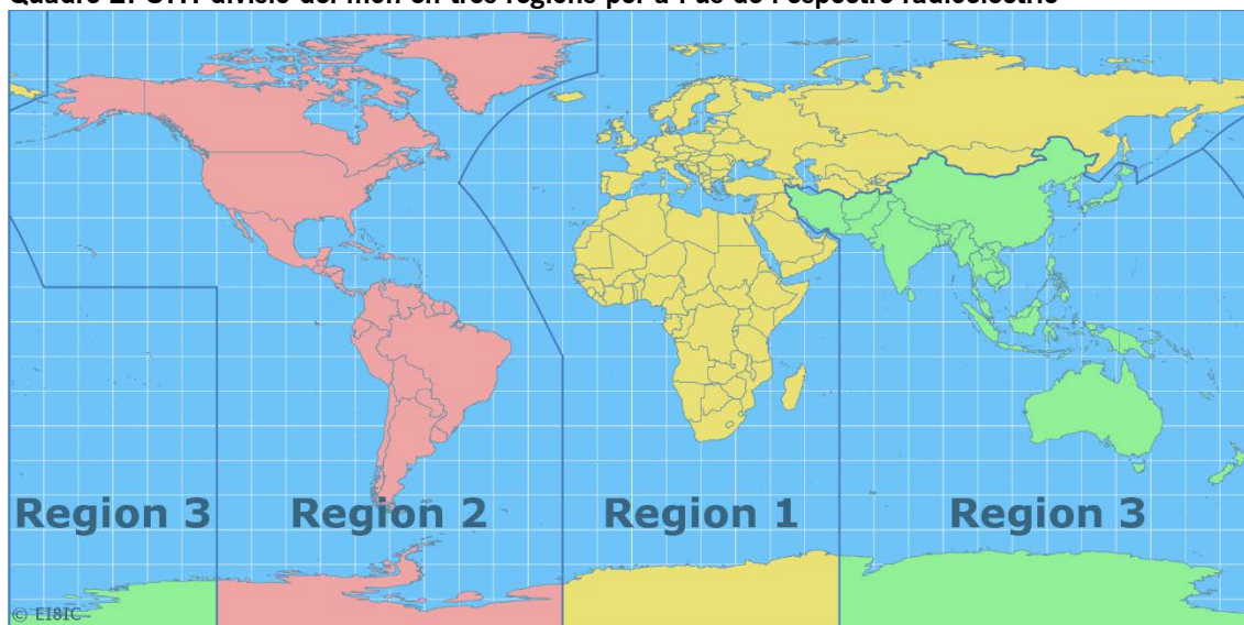
Quadre 2. UIT: divisió del món en tres regions per a l'ús de l'espectre radioelèctric
